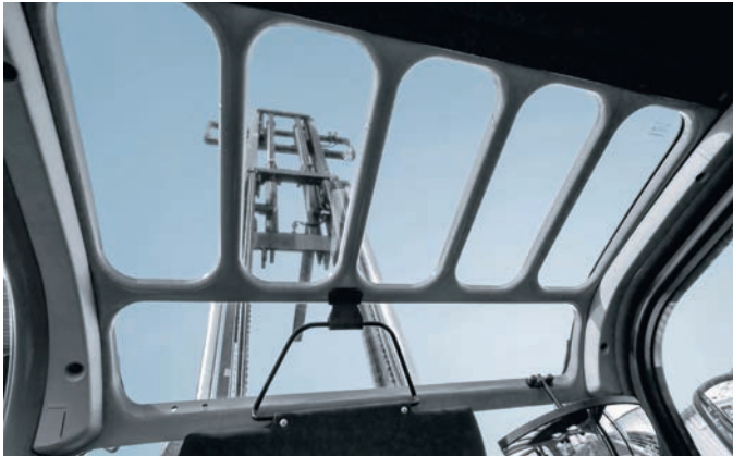
Beste Sicht durch zahlreiche Sichtfester und schmale Schutzdachprofile
