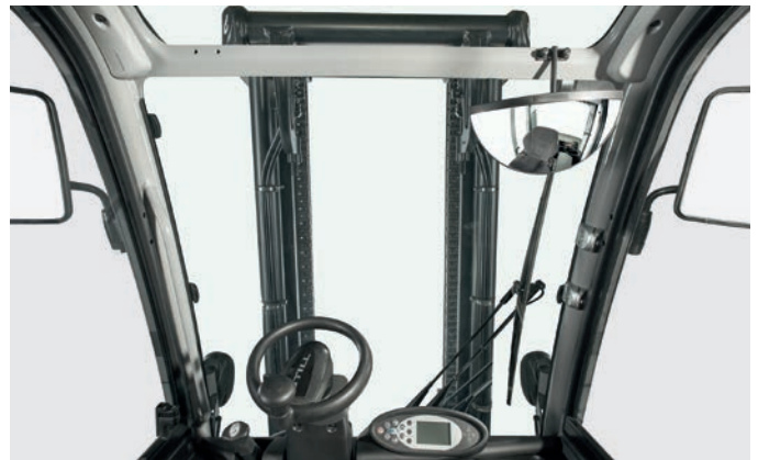
Schmale Hubgerüstprofile gewährleisten eine stets gute Sicht auf Gabeln und Last
