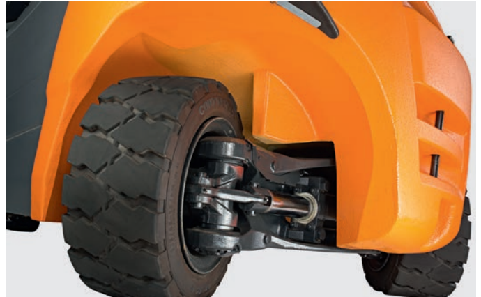
Wendig und standsicher durch hohes Pendellager
