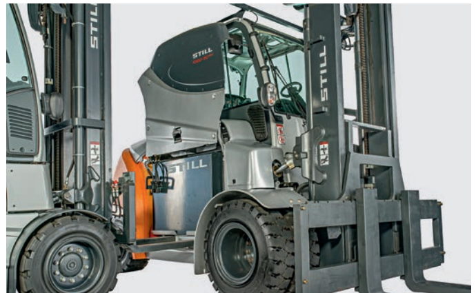
Hohe Verfügbarkeit durch schnellen Batteriewechsel
