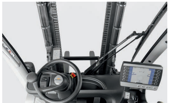
Tele-Hubgerüst für eine hervorragende Sicht nach vorn
