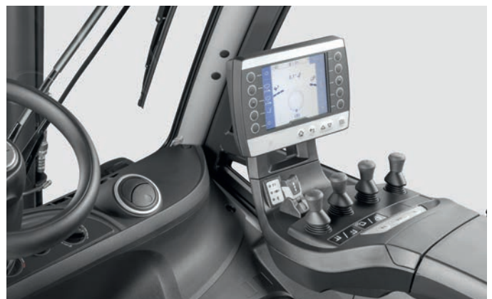
Sichere und intuitive Bedienung mit dem Anzeige- und Bedienmodul STILL Easy Control
