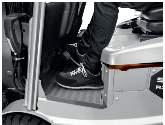
Für einen ergonomischen Arbeitsplatz und einen komfortablen Einstieg verfügt der RXE trotz seiner kompakten Abmessungen über einen geräumigen Fußraum
