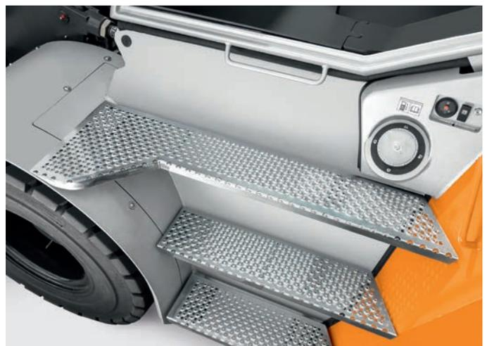
Große, rutschsichere und gut einsehbare Trittstufen für sicheres Ein- und Aussteigen in jeder Situation
