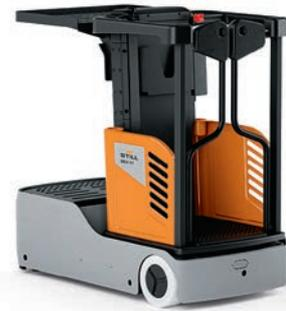
Sicherer als jede Leiter und praktischer als jedes verschiebbare Gerüst: Der OCV ist das perfekte Gerät für Arbeiten in bis zu 4,6 Metern Höhe, für schmale Gänge und für alle, die kleine Teile bis in die dritte Regalebene kommissionieren möchten.
