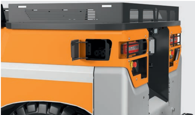
Sicheres und schnelles Laden ohne Öffnen der Batterietür dank optionaler Schnellladeklappe
