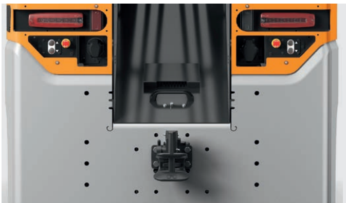
Für sicheres und effizientes An- und Abkuppeln sorgen Rücksteinrichtungen am Heck
