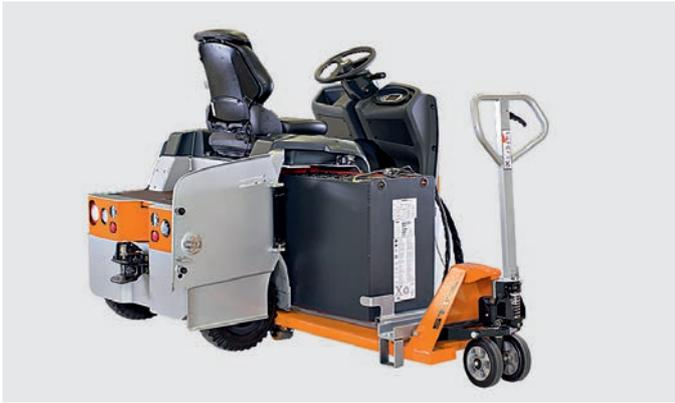
Für beste Fahrzeugverfügbarkeit und Ergonomie sorgt der bewährte seitliche Batteriewechsel von STILL
