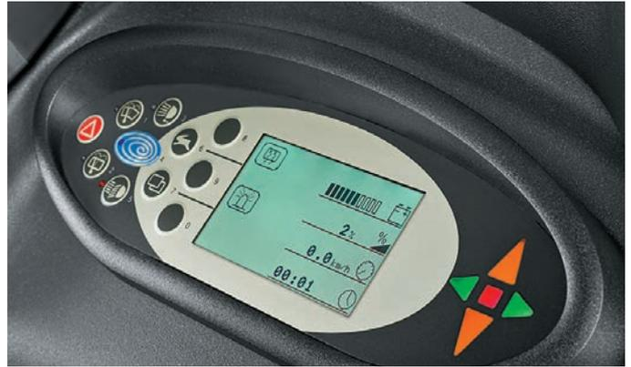
Immer sicher unterwegs mit dem STILL Ramp Indicator; er zeigt zuverlässig und auf einen Blick die aktuelle Neigung des Geländes an
