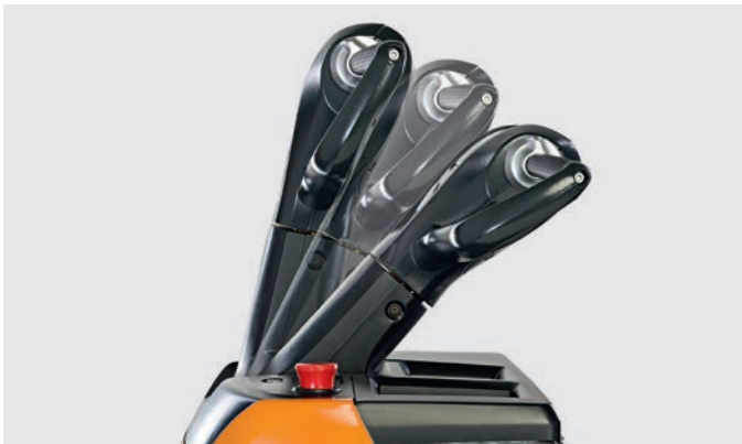
Höhenverstellbare Lenkung für unterschiedliche Fahrergrößen 1
