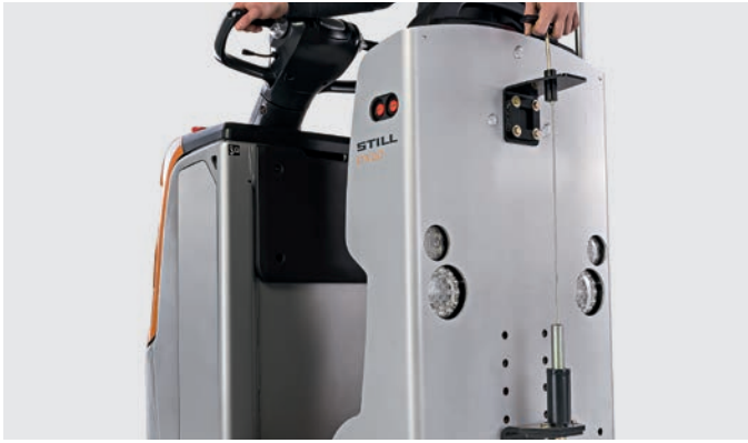
Schnelle Entriegelung der Kupplung vom Fahrerplatz aus 1
