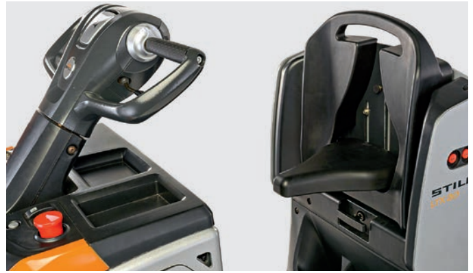
Ausklappbarer Sitz erleichtert lange Fahrstrecken 1
