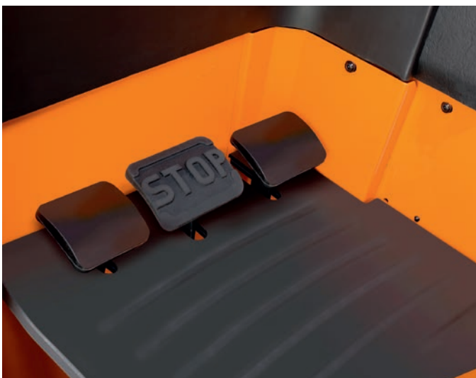
Präzision bis in die Fußspitzen mit Pedalerie für schnelle Fahrtrichtungswechsel
