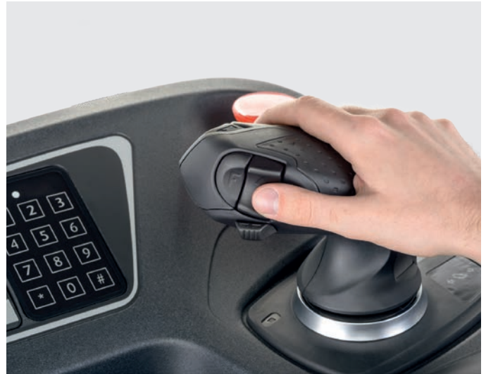
Individuelle Bedienung dank optionalem Joystick 4Plus für Hub-, Senk- und Fahrsteuerung ohne Umgreifen
