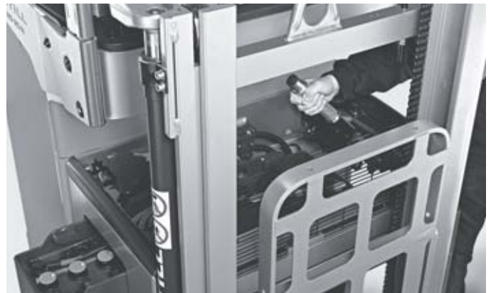
Serienmäßiger seitlicher Batteriewechsel für höchste Verfügbarkeit und Ergonomie
