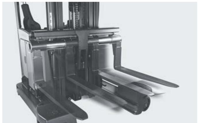
Sicheres Lasthandling durch hydraulische Gabelspreizung
