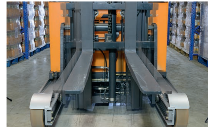
Gute Sicht auf die Ware durch einzigartigen Mastquerverschub
