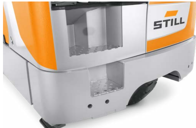
Sicherer Aufstieg durch zusätzliche Trittstufe
