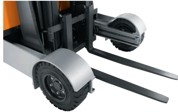
Superelastik-Bereifung mit Radschutz für mehr Sicherheit
