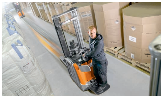
Höchste Umschlagleistung: Fahrgeschwindigkeit von bis zu 10 km/h
