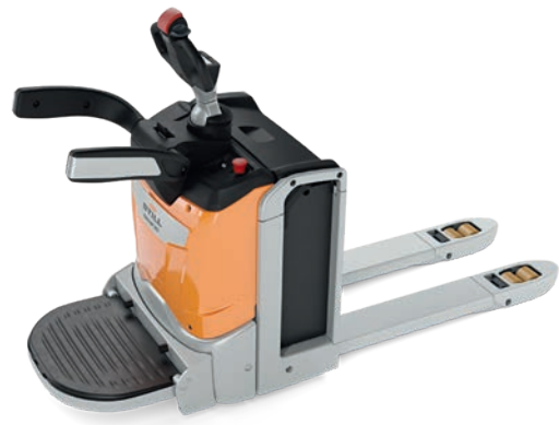
Die mechanisch gefederte Standplattform ermöglicht eine ergonomische Federung und gleichzeitig eine Steigerung der Umschlagleistung
