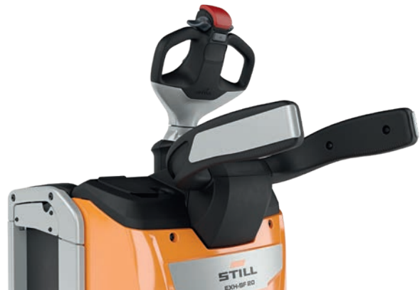
Sicherer und ergonomischer Stand auf der Plattform dank der faltbaren Seitenbügel
