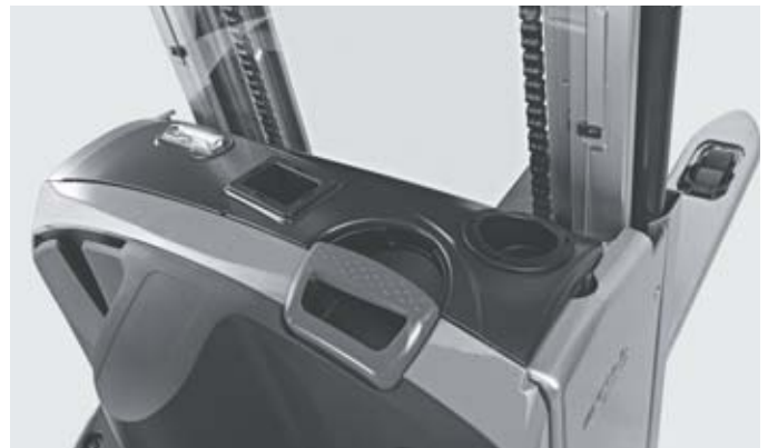
Die Batteriehaube aus Stahl ist nicht nur robust, sondern bietet zudem integrierte Ablagemöglichkeiten
