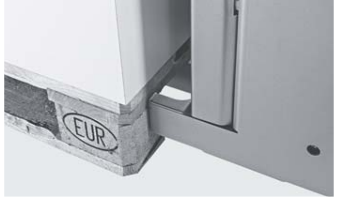
Präzises Stapeln auf zwei Stöcken mit der einzigartigen Palettenjustierhilfe des EXD 18
