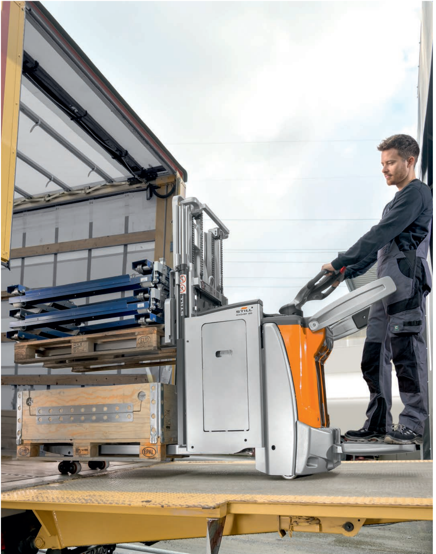
EXD-SF Doppelstock-Hochhubwagen mit klappbarer Fahrerstandplattform Immer zwei Paletten voraus
