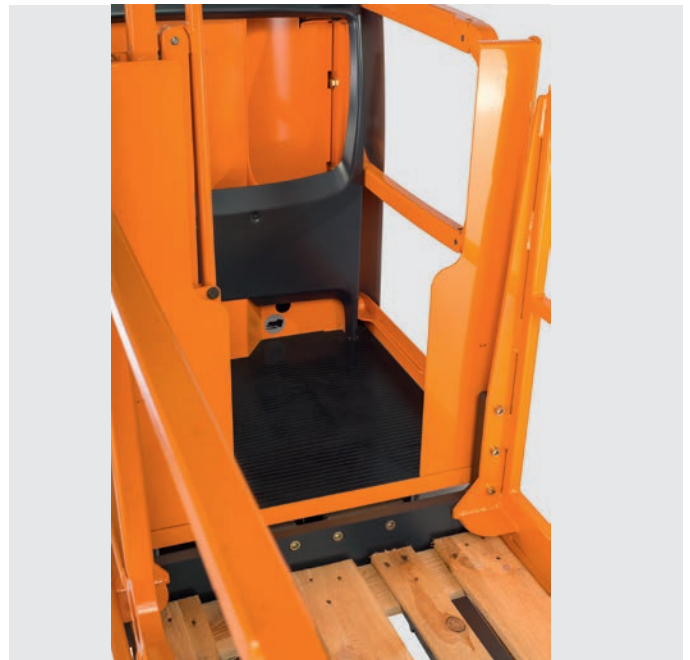
Einfaches und sicheres Betreten der Palette durch die zusätzliche Schranke in Lastrichtung
