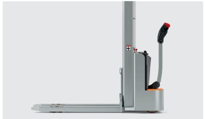
Kompaktes Vorbaumaß ermöglicht höchste Manövrierfähigkeit auch in schmalsten Arbeitsgängen; zugleich beste Standsicherheit dank des 4-Rad-Fahrwerks
