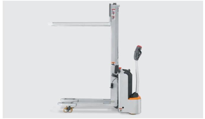
Bodenschwellen überwinden leicht gemacht dank optionalem Initialhub für mehr Bodenfreiheit beim ECV 10iC; außerdem immer sicher unterwegs aufgrund der hubhöhenabhängigen Geschwindigkeitsreduzierung
